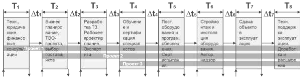
Рис. 6. Жизненный цикл проекта по строительству инфокоммуникационной сети
